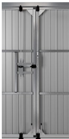
Aktivt blad låst i tre punkter, når H > 2.700 [mm] – set udefra.
